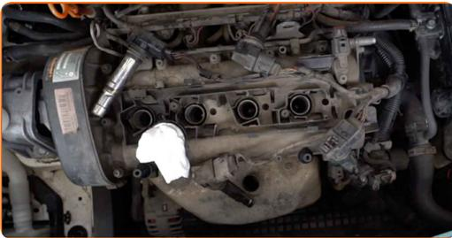
Substituição: bobina de ignição – VW Passat B6 Variant (3C5). AUTODOC recomenda:
