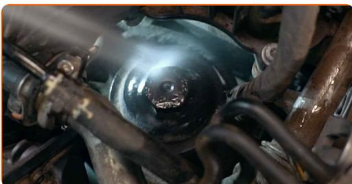
**7** Desaperte a tampa da caixa do filtro em conjunto com o antigo elemento do filtro. Use uma chave soquete nº 30. Use uma chave de catraca.
