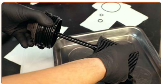
**16** Retire anéis em O antigos da tampa do filtro de óleo. Use uma chave de fenda plana.
