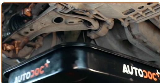
**12** Limpe a área do orifício de drenagem do cárter. Use uma escova metálica. Use o spray de limpeza universal.
