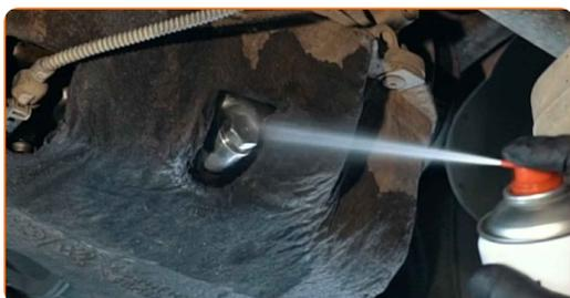
**13** Desaperte o bujão de drenagem. Use uma chave soquete n° 19. Use uma chave de catraca.
