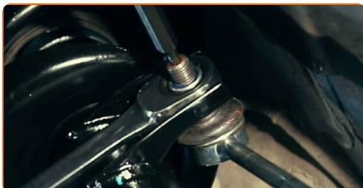
**12** Desaparafuse o fixador que conecta bieleta da barra estabilizadora à barra estabilizadora. Use uma chave soquete nº 19. Use uma chave de torque. Aperte-o para o torque de 65 Nm.
