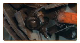
Desaperte o fixador que liga a rótula de suspensão ao braço da suspensão. Use uma chave soquete nº 16. Use uma chave de catraca.
