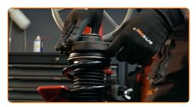
Aperte a porca do suporte do amortecedor da haste do pistão. Use uma chave soquete nº 21. Use HEX n.º H7. Use uma chave de torque. Aperte-o para o torque de 60 Nm.
