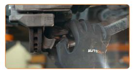
Aperte os fixadores que ligam a junta esférica ao braço de suspensão. Use uma chave soquete nº 16. Use uma chave de torque. Aperte-o para o torque de 60 Nm.
