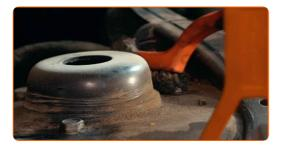
Solte os fixadores superiores do dispositivo amortecedor. Use uma chave soquete nº 13. Use uma chave de catraca.
