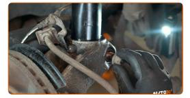
Aparafuse o fixador que conecta o amortecedor à manga de eixo. Use uma chave soquete nº 18. Use XZN #14. Use uma chave de catraca.
