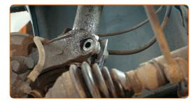
Desligar a manga de eixo do suporte do amortecedor.
