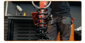
Instale a coifa e o batente de encosto no amortecedor.
