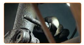
Solte o fixador inferior que conecta a coluna de suspensão às mangas de eixo. Use um cinzel plano para metal. Use um martelo.
