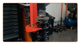
Retire a coluna de suspensão montada.
