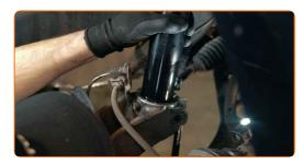
52 Instale o parafuso de fixação.
