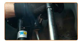
Instale a aperte o parafuso do eixo de transmissão. Use uma chave soquete nº 27. Use uma chave de catraca.
