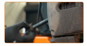
Desaparafuse o elemento de fixação inferior que liga a coluna de suspensão às mangas de eixo. Use uma chave soquete nº 18. Use XZN #14. Use uma chave de catraca.
