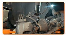
Desaperte os fixadores superiores da coluna de suspensão.
