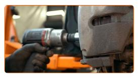
Remova o parafuso de fixação.
