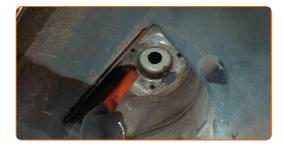
Instale o amortecedor no arco da roda.
