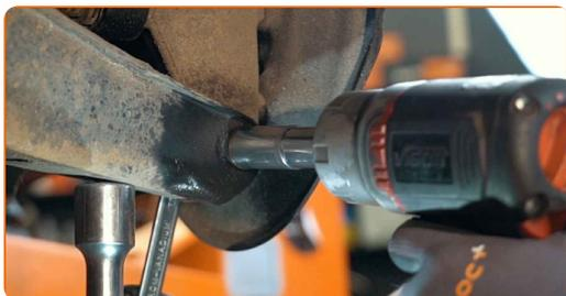
**13** Remova o parafuso de fixação.
