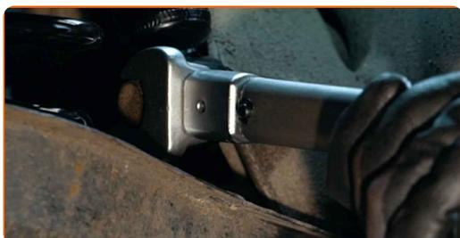
**39** Aperte o fixador do braço inferior. Use uma chave combinada nº 18. Use uma chave soquete nº 18. Use uma chave de torque. Aperte-o para o torque de 90 Nm.+90°
