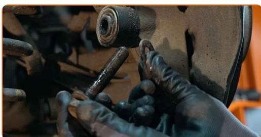
**16** Desaperte a fixação superior do amortecedor. Use uma chave soquete nº 16. Use uma chave de catraca.
