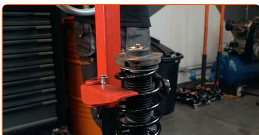
**48** Retire a coluna de suspensão montada.
