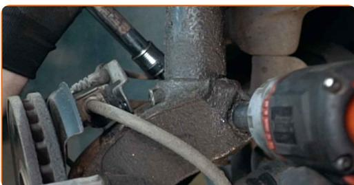
**21** Limpe os fixadores que conectam a rótula de suspensão ao braço da suspensão. Use uma escova metálica. Use spray WD-40.
