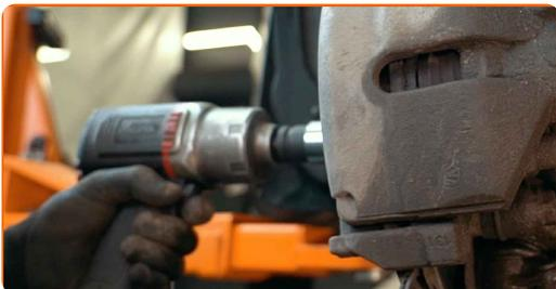
**19** Remova o parafuso de fixação.
