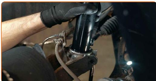
**54** Instale o parafuso de fixação.
