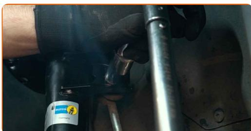
**67** Instale e aperte o parafuso do eixo de transmissão. Use uma chave soquete nº 27. Use uma chave de catraca.
