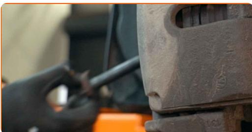
**20** Desaparafuse o elemento de fixação inferior que liga a coluna de suspensão às mangas de eixo. Use uma chave soquete nº 18. Use XZN #14. Use uma chave de catraca.
