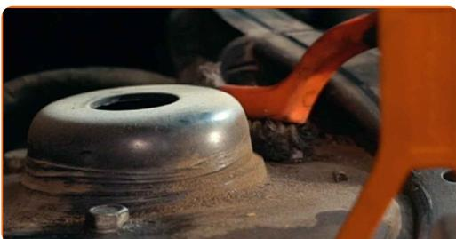
**7** Solte os fixadores superiores do dispositivo amortecedor. Use uma chave soquete nº 13. Use uma chave de catraca.
