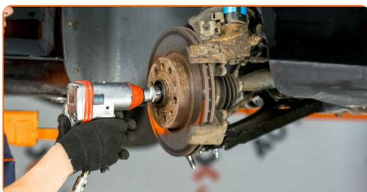
**53** Instale o terminal do estabilizador transversal. Desaparafuse o fixador que conecta bieleta da barra estabilizadora à barra estabilizadora. Use uma chave soquete nº 19. Use uma chave de torque. Aperte-o para o torque de 60 Nm.
