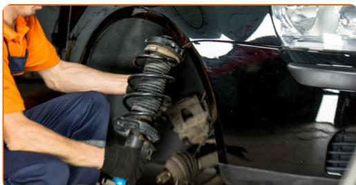
**41** Aparafuse a fixação superior de montagem do suporte do amortecedor. Não o aperte.
