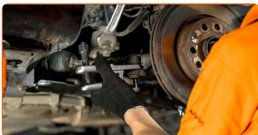
**9.1** Desconecte a instalação elétrica e a mangueira de travão do suporte das mangas de eixo.
