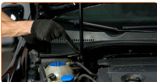
**27** Limpe os fixadores da montagem superior do suporte do amortecedor. Use spray WD-40.
