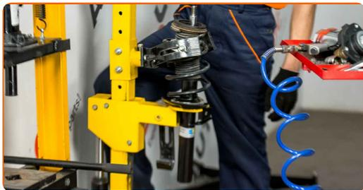
**39** Retire a coluna de suspensão montada.
