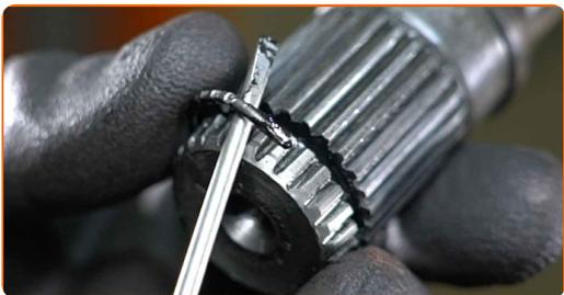
**32** Instale o fole da junta homocinética no eixo da junta homocinética. Use uma chave de fenda plana.
