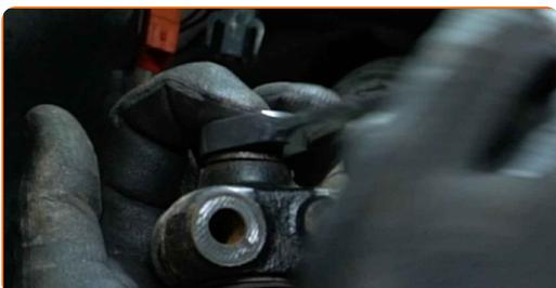
**15** Remova o parafuso de fixação. Use um saca-pino. Use um martelo.
