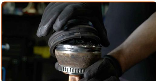
**30** Limpe o assento de montagem da junta homocinética. Use o spray de limpeza universal.
