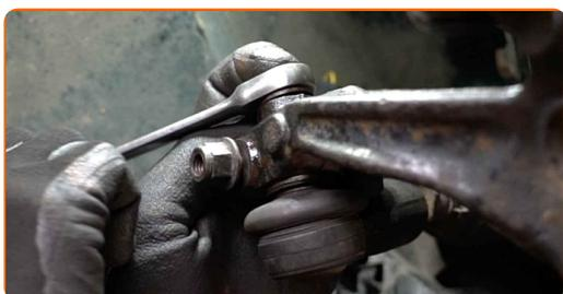
**44** Instale o parafuso de fixação.
