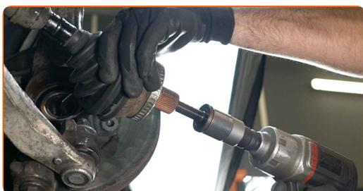
**27** Remova o parafuso de fixação.
