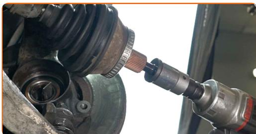
**26** Desaperte o fixador que liga o eixo de transmissão ao cubo de roda.
