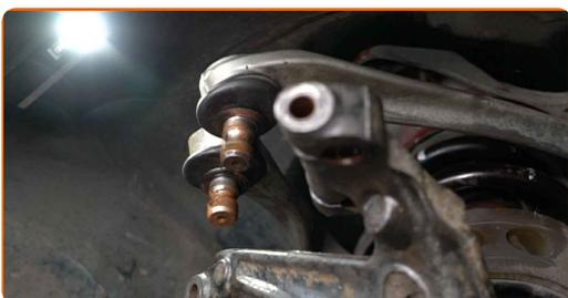
**20** Desconecte o terminal de direção da manga de eixo.
