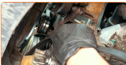
Substituição: correia trapezoidal estriada – VW PASSAT Variant (3B5).
