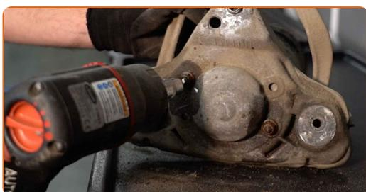
**28** Remova o suporte superior do amortecedor que se encontra montado com os braços de suspensão.
