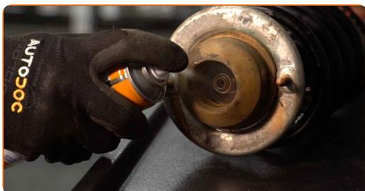
**44** Instale o suporte superior do amortecedor que se encontra montado com os braços de suspensão.
