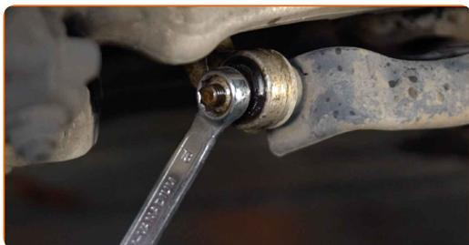
**18** Desaparafuse o fixador que conecta a barra estabilizadora ao braço. Use uma chave combinada nº 16 (2 peças).
