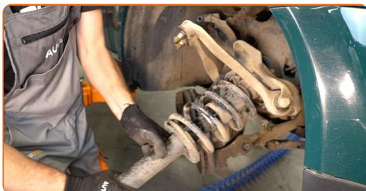
**26** Limpe os fixadores da montagem superior do suporte do amortecedor. Use uma escova metálica. Use spray WD-40.
