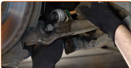
**63** Aperte o fixador que conecta a barra estabilizadora ao braço. Use uma chave combinada nº 16. Use uma chave soquete nº 16. Use uma chave de torque. Aperte-o para o torque de 40 Nm.+90°
