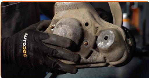
**45** Aperte a fixação superior da montagem do suporte do amortecedor. Use uma chave soquete nº 13. Use uma chave de torque. Aperte-o para o torque de 22 Nm.
