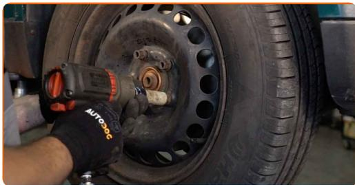
**70** Baixar o carro e trabalhar em ordem transversal, apertar os parafusos das rodas. Use uma chave de torque. Aperte-o para o torque de 120 Nm.
