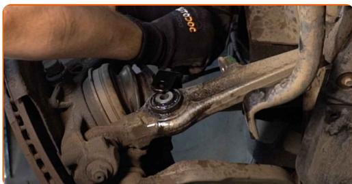
**50** Instale o parafuso de fixação.
