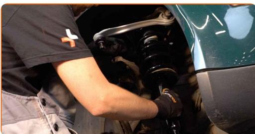
**47** Aparafuse a fixação superior de montagem do suporte do amortecedor. Use uma chave soquete nº 15. Use uma chave de catraca. Não o aperte.
