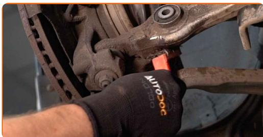
**49** Conecte o braço da suspensão à coluna de suspensão.
