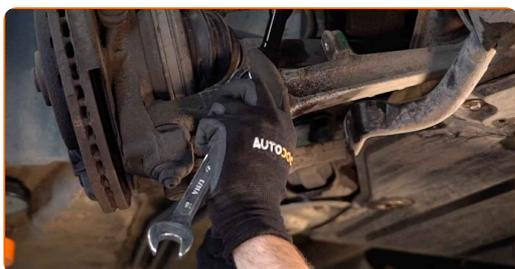
**52** Limpe os locais de montagem e a rosca do braço da suspensão. Use uma escova metálica. Use spray WD-40.
