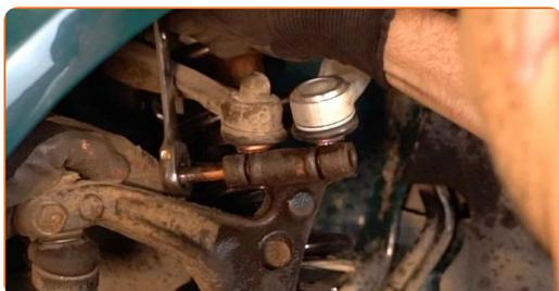
**56** Aparafuse os fixadores (duas peças) do braço de suspensão superior. Use uma chave combinada nº 16. Use uma chave soquete nº 16.
