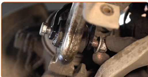
**51** Aparafuse o elemento de fixação inferior do amortecedor. Use uma chave combinada nº 18. Use uma chave soquete nº 18.
