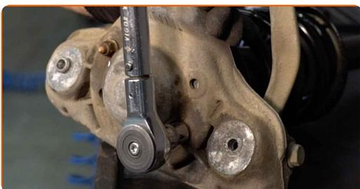
**46** Instale o amortecedor no arco da roda.
