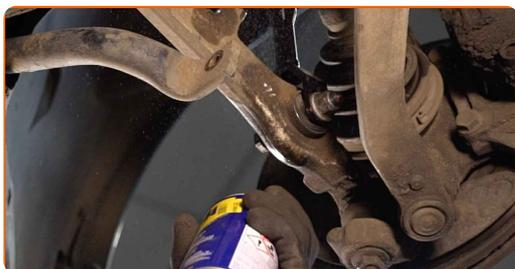
**62** Instale o terminal do estabilizador transversal.
