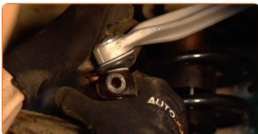
**55** Instale o parafuso de fixação.
