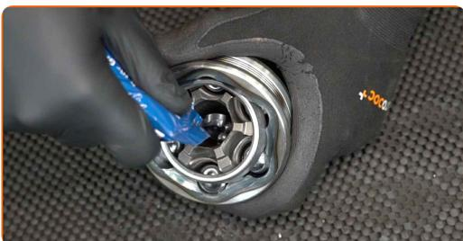
**31** Desloque o anel interior da nova junta homocinética de um lado para o outro, de modo a preparar o seu funcionamento.
