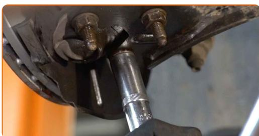
**43** Limpe os assentos de montagem do tirante da barra estabilizadora. Use uma escova metálica. Use spray WD-40.
