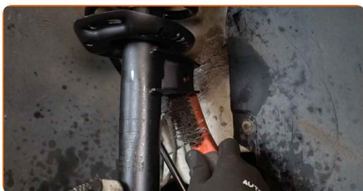
**44** Instale o terminal do estabilizador transversal.
