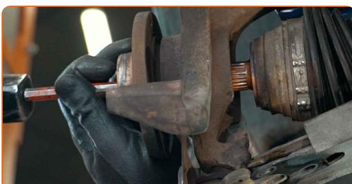
Substituição: rolamento da roda – VW POLO (6N2). AUTODOC recomenda:
