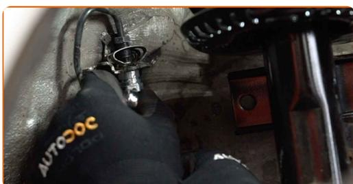
**15** Aperte o elemento de fixação que liga o tubo de freio à pinça do travão. Use uma chave soquete nº 11. Use uma chave de torque. Aperte-o para o torque de 30 Nm.
