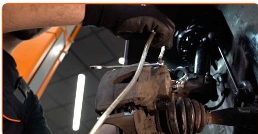
**21** Pressione o pedal do travão várias vezes para remover o ar do sistema.
