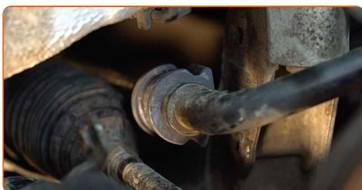
**14** Instale os suportes da bucha da barra estabilizadora.
