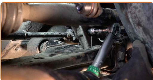
Substituição: casquilho da barra estabilizadora – VW POLO (9N\_). AUTODOC recomenda:
