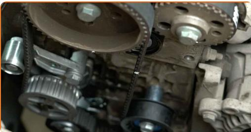
**Substituição: bomba de água + kit de distribuição – VW POLO (9N\_).**
