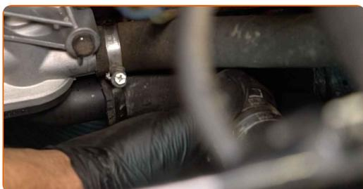
**15** Fixe a braçadeira de fixação da mangueira do líquido de refrigeração. Use uma chave soquete nº 7. Use uma chave de catraca.
