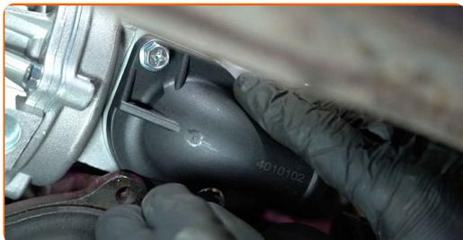
**13** Aperte os fixadores da carcaça do termóstato. Use uma chave soquete nº 10. Use uma chave de torque. Aperte-o para o torque de 13 Nm.
