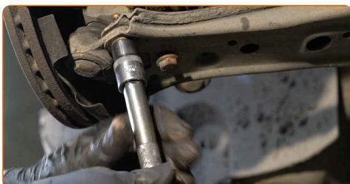
**55** Aperte o fixador da articulação esférica. Use uma chave soquete nº 13. Use uma chave de torque. Aperte-o para o torque de 20 Nm.+90°
