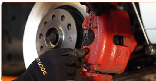
**20** Trate a superfície onde o disco de travão entra em contacto com o aro da roda. Use massa de cobre.
