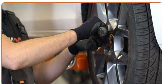
**24** Baixar o carro e trabalhar em ordem transversal, apertar os parafusos das rodas. Use uma chave de torque. Aperte-o para o torque de 120 Nm.
