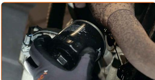
Substituição: óleo do motor e filtro – VW Polo Hatchback (6R1, 6C1). Os profissionais recomendam:
