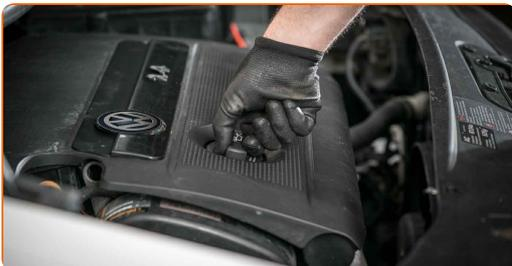
**18** Ligue o motor por alguns minutos. Após a luz de advertência da pressão do óleo se apagar, desligue o motor.
