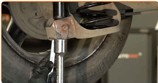
**12** Desaperte a fixação inferior do amortecedor. Use uma chave combinada nº 16. Use uma chave soquete nº 16. Use uma chave de catraca.
