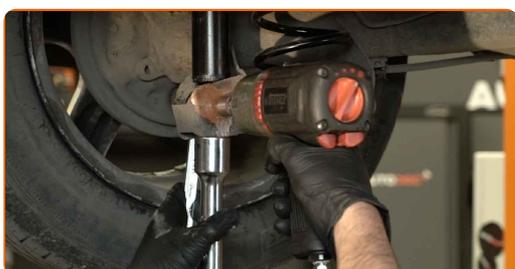
**13** Remova o parafuso de fixação.
