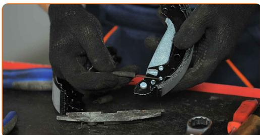
**19** Coloque as sapatas de travão de modo a que os seus bordos interiores fiquem assentes na placa de ancoragem.
