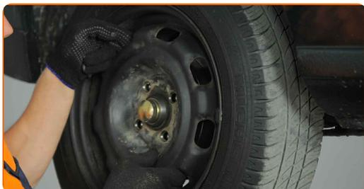
**7** Retire a tampa de proteção de rolamento de cubo. Use um cinzel plano para metal. Use um martelo. Use uma chave de fenda plana.
