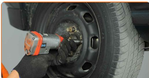
**32** Baixe o carro e trabalhar em ordem transversal, apertar os parafusos das rodas. Use o soquete de impacto para roda #17. Use uma chave de torque. Aperte-o para o torque de 120 Nm.
