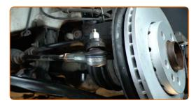
Aparafuse no terminal de direção a contraporca. Use uma chave combinada nº 19. Use uma chave combinada nº 21.
