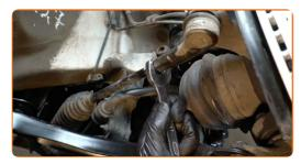
Desenrosque a extremidade da porca de fixação da manga de eixo. Use uma chave soquete nº 19. Use uma chave de tarraxa.
