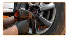
Baixar o carro e trabalhar em ordem transversal, apertar os parafusos das rodas. Use o soquete de impacto para roda #17. Use uma chave de torque. Aperte-o para o torque de 120 Nm.
