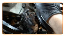
Aparafuse a porca de fixação que liga o terminal de direção à manga do eixo. Use uma chave soquete nº 18. Use uma chave de catraca.
