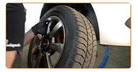
Limpe o elemento de fixação que conecta o terminal de direção à manga de eixo. Use uma escova metálica. Use spray WD-40.
