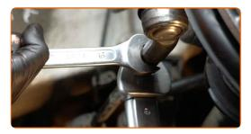
Aperte a porca de fixação conectada ao terminal de direção à manga de eixo. Use uma chave soquete nº 18. Use uma chave de torque. Aperte-o para o torque de 20 Nm.+90°
