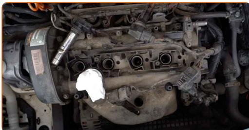
**Substituição: bobina de ignição – VW Polo V Hatchback (6R1, 6C1). AUTODOC recomenda:**
