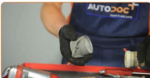
Substituição: cabeçotes do amortecedores – VW POLO VIVO Hatchback.
