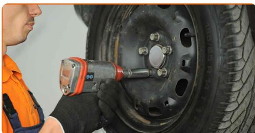
**30** Baixar o carro e trabalhar em ordem transversal, apertar os parafusos das rodas. Use o soquete de impacto para roda #17. Use uma chave de torque. Aperte-o para o torque de 120 Nm.
