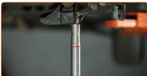
**7** Limpe os elementos de fixação do amortecedor. Use uma escova metálica. Use spray WD-40.
