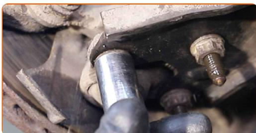
**69** Instale o terminal do estabilizador transversal.
