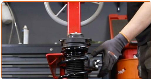
**52** Trate a haste da coluna do amortecedor. Use massa de cobre.
