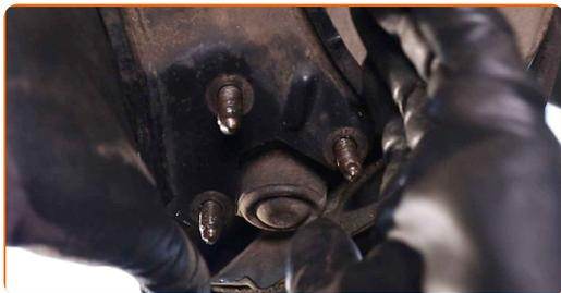
**68** Aperte os parafusos que ligam a junta esférica ao braço de suspensão. Use uma chave soquete nº 16. Use uma chave de catraca.
