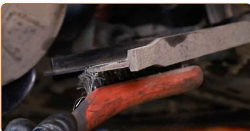
**58** Limpe o local de montagem da torre da suspensão na manga do eixo. Limpe o local de montagem da junta homocinética. Use uma escova metálica. Use spray WD-40.
