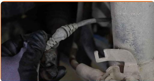
**19** Limpe o parafuso que liga o suporte da mangueira do travão à torre da suspensão. Use uma escova metálica. Use spray WD-40.
