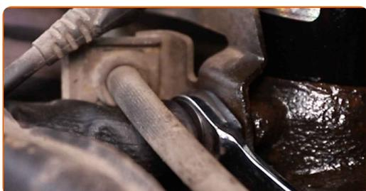
**77** Aperte o suporte de fixação da mangueira do travão do amortecedor. Use uma chave soquete nº 10. Use uma chave de torque. Aperte-o para o torque de 12 Nm.
