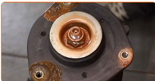
**53** Retire a coluna de suspensão montada.
