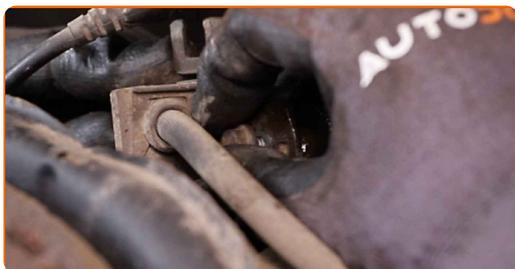
**76** Aperte o fixador que liga o suporte da mangueira do travão à torre da suspensão. Use uma chave combinada nº 10.
