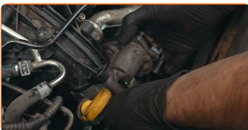
**56** Aperte os fixadores do corpo borboleta ao coletor de admissão de ar. Use Torx T27. Use uma chave de torque. Aperte-o para o torque de 14 Nm.
