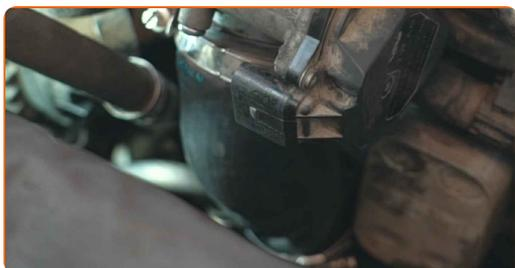
**60** Aparafuse o fixador do tubo da vareta de medição. Use uma chave combinada nº 10.
