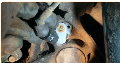
**15** Aperte o fixador que liga o sensor ABS à manga de eixo. Use HEX n.º H5. Use uma chave de torque. Aperte-o para o torque de 7 Nm.
