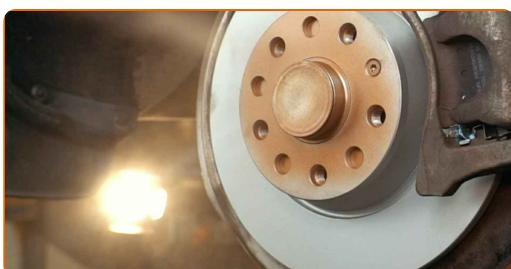
**18** Limpe a superfície do disco de travão. Utilize um produto de limpeza para travões.
