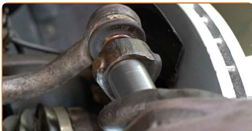
10 Desconecte o terminal de direção da manga de eixo.
