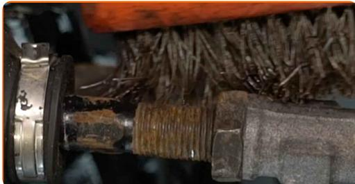
8 Solte a porca de bloqueio que prende o terminal de direção à barra de direção. Use uma chave combinada nº 22 (2 peças).
