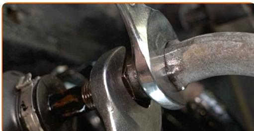
9 Desenrosque a extremidade da porca de fixação da manga de eixo. Use uma chave soquete nº 18. Use uma chave de catraca.
