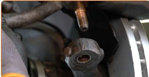
Substituição: terminal de direção – VW Sharan VAN (7M). Conselho:
