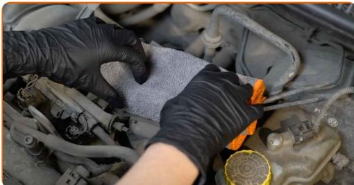
**6** Desaperte os parafusos de fixação da tampa do filtro de ar. Use a chave Phillips.
