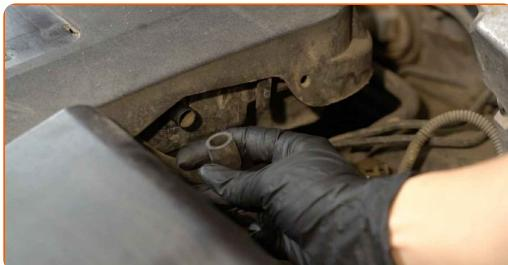
**4** Retire a tampa do motor. A caixa do filtro de ar está integrado na tampa do motor.
