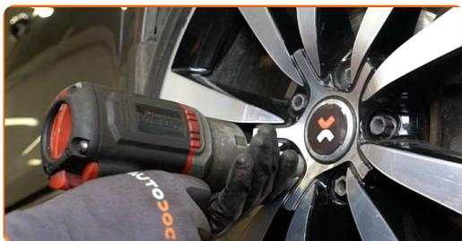
**67** Baixar o carro e trabalhar em ordem transversal, apertar os parafusos das rodas. Use o soquete de impacto para roda #17. Use uma chave de torque. Aperte-o para o torque de 120 Nm.
