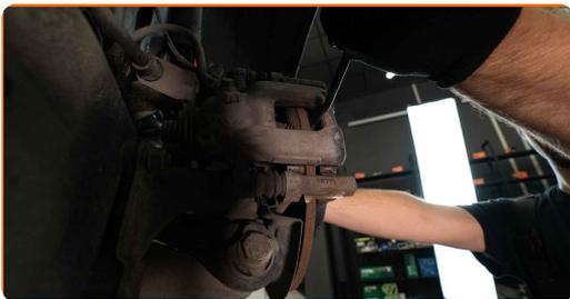
**9** Limpe os fixadores do suporte da pinça de travão. Use uma escova metálica. Trate os fixadores do suporte da pinça de travão. Use spray WD-40.
