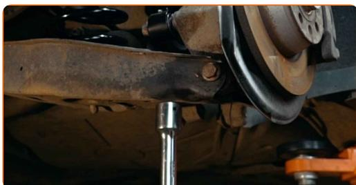
**18** Aperte o fixador do braço inferior. Use uma chave combinada nº 18. Use uma chave soquete nº 18. Use uma chave de torque. Aperte-o para o torque de 90 Nm.+90°
