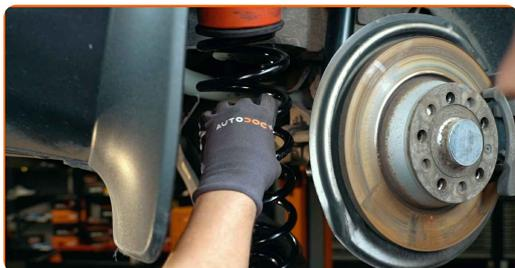
**14** Limpe os locais de montagem e a rosca do braço da suspensão. Use uma escova metálica. Use spray WD-40.
