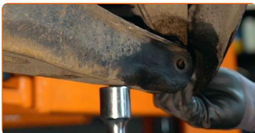
**16** Instale o parafuso de fixação.
