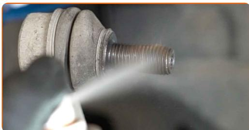
**53** Instale o terminal do estabilizador transversal.
