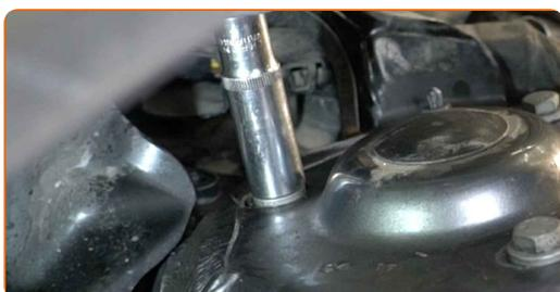
**70** Trate os fixadores do apoio da coluna de suspensão. Use massa de cobre.
