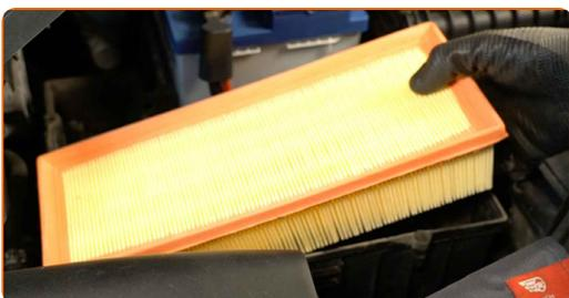
Substituição: filtro de ar – Passat Variant B6. Conselho:
