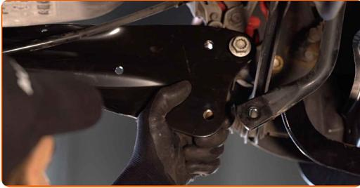
20 Aperte os fixadores que conectam o braço de controlo à manga traseira. Use uma chave soquete nº 18. Use uma chave de torque. Aperte-o para o torque de 90 Nm.+90°
