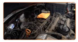
Desconecte a mangueira de ventilação do cárter do tubo de enchimento de óleo.
