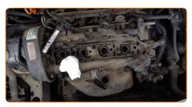
Substituição: bobina de ignição – VW Touran I (1T1, 1T2). AUTODOC recomenda:
