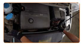
Desconecte a mangueira de ventilação do cárter da tampa do motor.
