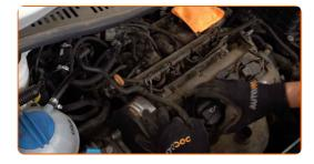
Desaperte o tubo de enchimento de óleo. Retire o tubo de enchimento de óleo.
