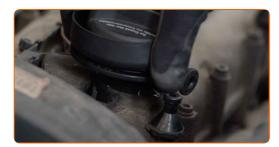
Conecte a mangueira de ventilação do cárter ao tubo de enchimento de óleo.
