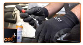
Ligue o conector da bobina de ignição.
