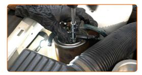
Aparafuse o suporte de montagem do filtro de combustível. Use uma chave soquete nº 13. Use uma chave de catraca.
