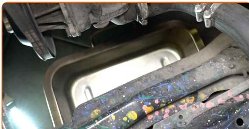
5 Solte a braçadeira de fixação da mangueira do líquido de refrigeração. Use uma chave soquete nº 7. Use uma chave de catraca.
