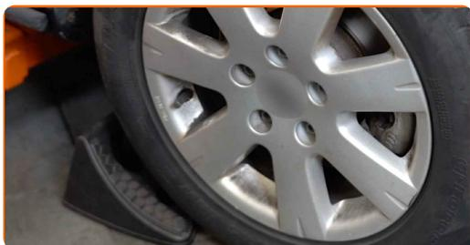
**2** Solte os parafusos de montagem das rodas. Use o soquete de impacto para roda #17.
