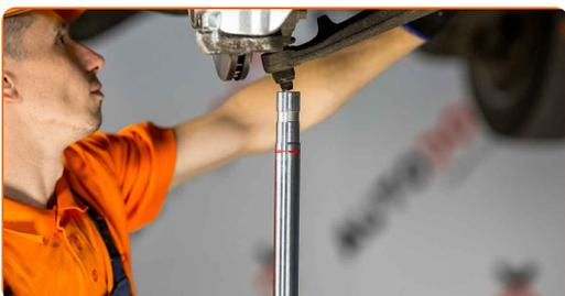
**30** Apertar a fixação da subestrutura. Use uma chave soquete nº 21. Use uma chave de catraca.
