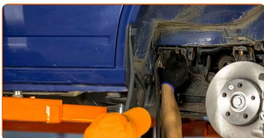
**35** Aperte os parafusos do braço de suspensão superior (2 peças). Use uma chave combinada nº 21. Use uma chave soquete nº 21. Use uma chave de torque. Aperte-o para o torque de 160 Nm.
