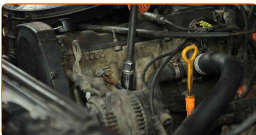
**Substituição: vela de ignição – VW Transporter IV Minibus (70B, 70C, 7DB, 7DK, 70J, 70K, 7DC, 7DJ).** Os profissionais recomendam:
