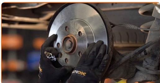
**22** Aperte a fixação do disco de travão. Use HEX n.º H6. Use uma chave de torque. Aperte-o para o torque de 9 Nm.
