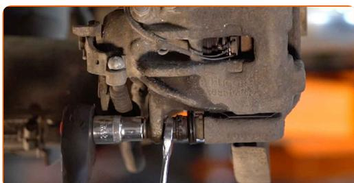
**10** Desconecte o sensor do indicador de desgaste das pastilhas de travão.
