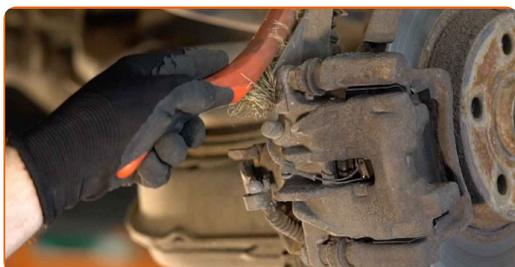
Substituição: discos de travão – VW Transporter IV Van (70A, 70H, 7DA, 7DH).
