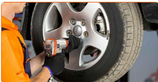
**23** Baixar o carro e trabalhar em ordem transversal, apertar os parafusos das rodas. Use uma chave de torque. Aperte-o para o torque de 160 Nm.
