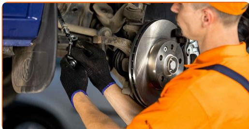
Substituição: terminal de direção – VW Transporter IV Van (70A, 70H, 7DA, 7DH). AUTODOC recomenda:
