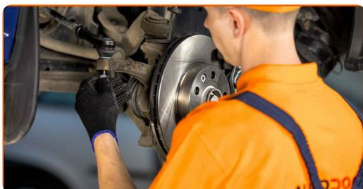
**16** Aperte a porca de fixação conectada ao terminal de direção à manga de eixo. Use uma chave soquete nº 19. Use uma chave de torque. Aperte-o para o torque de 40 Nm.
