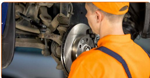
**15** Aparafuse a porca de fixação que liga o terminal de direção à manga do eixo. Use uma chave soquete nº 19.
