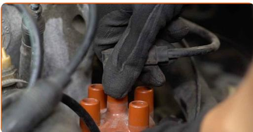
Substituição: rotor do distribuidor – VW Transporter T3 Camião de plataforma/Chassis. Conselho da AUTODOC:
