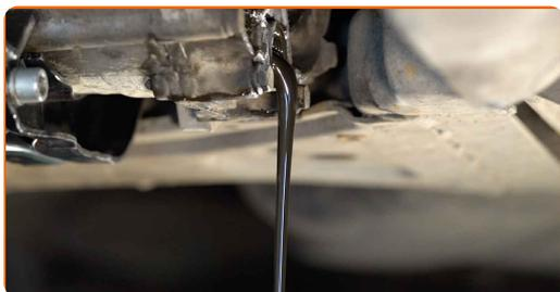
Substituição: óleo da caixa de velocidades manual – VW Transporter T3
