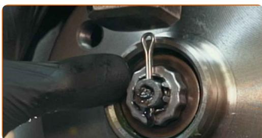
**31** Instale a tampa da porca do cubo. Use um martelo de borracha.
