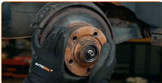
**18** Limpe a manga de eixo. Use uma escova metálica. Use o spray de limpeza universal.
