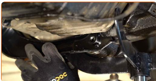
**12** Instale os parafusos de fixação.
