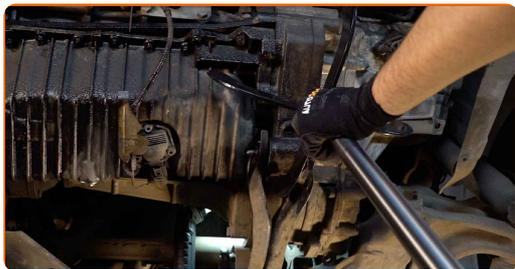
Substituição: apoios de motor – VW Transporter T4 Camião de plataforma / Chassis (70E, 70L, 70M, 7DE, 7DL, 7D). Conselho:
