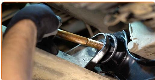
**13** Aparafuse os fixadores do apoio do motor. Use HEX n.º H10. Use uma chave soquete n.º 21. Use uma chave de catraca.
