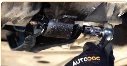
Substituição: apoios de motor – VW Transporter T4 Camião de plataforma / Chassis (70E, 70L, 70M, 7DE, 7DL, 7D). Os especialistas da AUTODOC recomendam:
