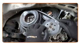
Aperte os fixadores da bomba de direção assistida hidráulica. Use uma chave soquete nº 13. Use uma chave soquete nº 16. Use uma chave de torque. Respeite o binário de aperto recomendado.
