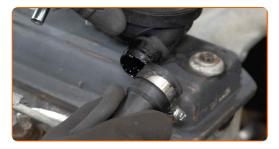
Desconecte a braçadeira da mangueira de ventilação do cárter. Use uma chave soquete nº 7. Use uma chave de catraca.
