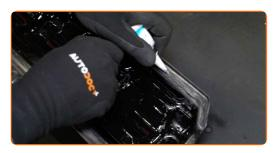
87 Instale junta da cobertura da válvula do motor.
