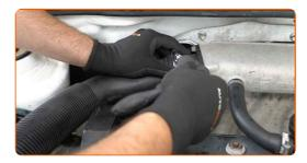
Remova a tampa do depósito do líquido de refrigeração.
