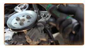
Limpe o assento de montagem da polia de tensão da correia de distribuição. Use uma escova metálica. Use o spray de limpeza universal.
