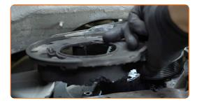
Vire a engrenagem da cambota. Use a chave de caixa de 12 pontos n.º 19. Use uma chave de catraca.
