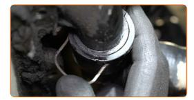
74 Instale a bomba hidráulica da direção assistida.
