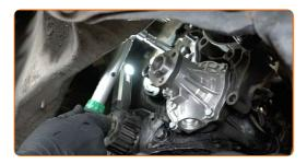
Trate do assento de montagem da polia da bomba de vácuo. Use o spray de limpeza universal.
