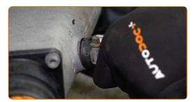
Aperte a braçadeira da mangueira de ventilação do cárter. Use uma chave soquete nº 7. Use uma chave de catraca.
