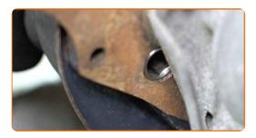
Desconecte a braçadeira da mangueira de ventilação do cárter. Use uma chave soquete nº 7. Use uma chave de catraca.
