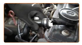
Desaparafuse os fixadores da cobertura da válvula do motor. Use uma chave soquete nº 10. Use uma chave de catraca.
