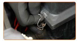
Aparafuse os fixadores do conjunto da caixa de distribuição de ar. Use uma chave soquete nº 7. Use uma chave de catraca.
