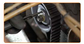
Remova a ferramenta de bloqueio da polia da bomba de combustível de alta pressão.
