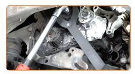
Conecte o tubo inferior do líquido de refrigeração.
