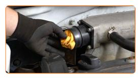
Solte os retentores da carcaça do filtro de ar. Retirar a caixa do filtro de ar.
