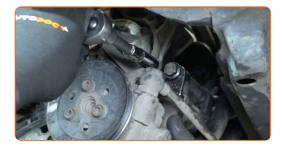
Remova a bomba hidráulica da direção assistida.
