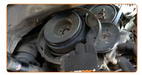
Limpe os fixadores do alternador. Use uma escova metálica. Use spray WD-40.
