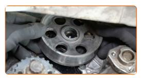
Desaparafuse os fixadores da bomba de direção assistida hidráulica. Use uma chave soquete nº 13. Use uma chave soquete nº 16. Use uma chave de catraca.
