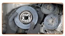
Limpe o fixador da polia da bomba de água. Use uma escova metálica. Use o spray de limpeza universal.
