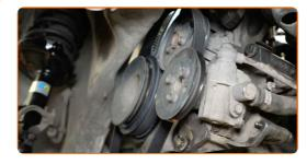
Limpe os fixadores das polias da cambota. Use uma escova metálica. Use spray WD-40.
