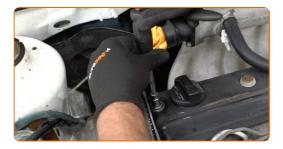
Remova a cobertura da válvula do motor.
