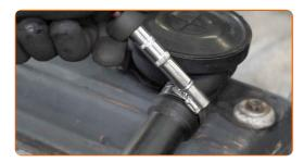
Desconecte a mangueira de ventilação do cárter.
