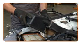
Desaparafuse os fixadores do conjunto da caixa de distribuição de ar. Use uma chave soquete nº 7. Use uma chave de catraca.
