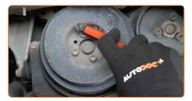
Desaparafuse o fixador das polias da cambota. Use HEX n.º H6. Use uma chave de catraca.
