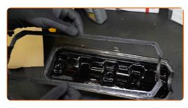
Instale a cobertura da válvula do motor.
