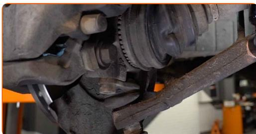
**25** Aperte a fixação inferior do amortecedor. Use uma chave soquete nº 21. Use uma chave de torque. Aperte-o para o torque de 120 Nm.
