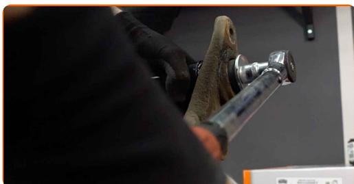
**Substituição: amortecedor – VW Transporter T4 Van (70A, 70H, 7DA, 7DH). Os profissionais recomendam:**
