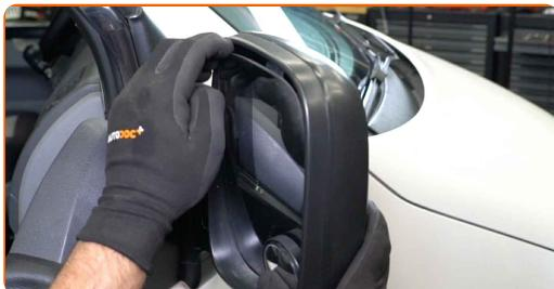
**3** Solte cuidadosamente o vidro do seu encaixe. Utilize uma ferramenta de acabamento de plástico. Use uma chave de fenda plana.
